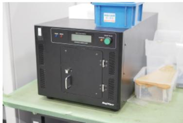
磁気破壊装置
